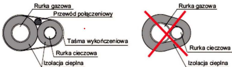
Rysunek - Sposób izolowania rurociągów.
